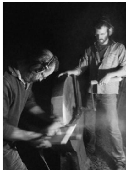
*Une grosse meule récupéré par Dimitri. Initialement entraînée par un moteur il a adapté une manivelle et fait un gabarit. L'inertie, le grand diamètre et le grain fin de la meule permet un bon travail.*
