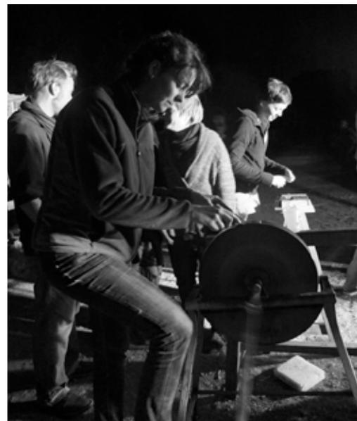
*Utilisation d'une meule portable qui a entre autre l'avantage de pouvoir tourner avec une pédale. Cela a l'avantage de laisser les 2 mains libres pour l'affûtage.*
