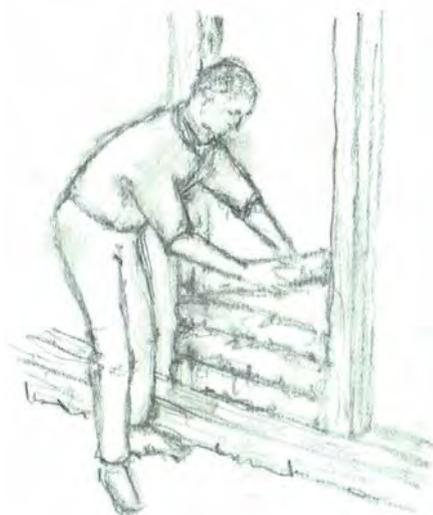
*Illustration 29: Les fuseaux juxtaposés sont placés frais dans les cadres des colombages. Finition d'égalisation avec un enduit ou forme de torchis plaqué.*
